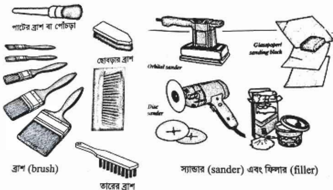
চিত্র ১০: দেয়ালের সৌন্দর্যমণ্ডিত কাজের জন্য ব্যবহৃত বিভিন্ন যন্ত্রপাতি ও টুলস
