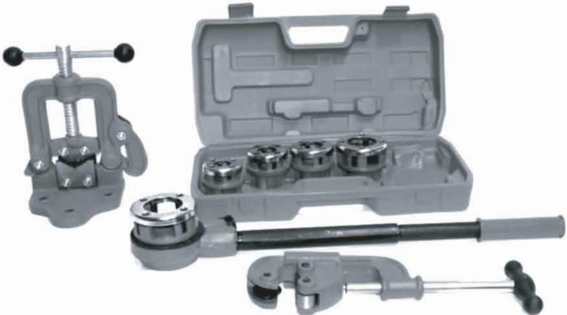
চিত্র: ২.১১ পাইপ কাটার, স্টক ডাইস এবং ক্লাম্প পাইপ ডাইস।
