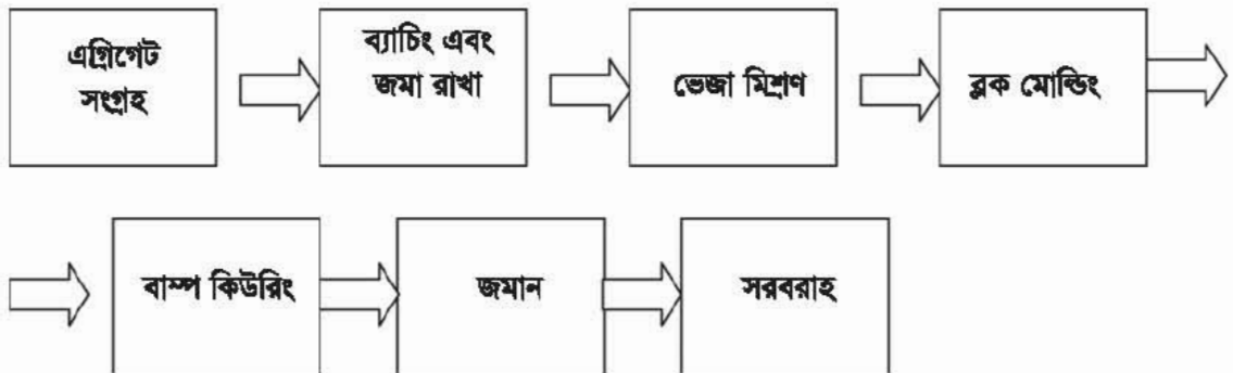
চিত্র ১৩.২ : ফাঁপা ব্লক নির্মাণপ্রবাহ চিত্র
